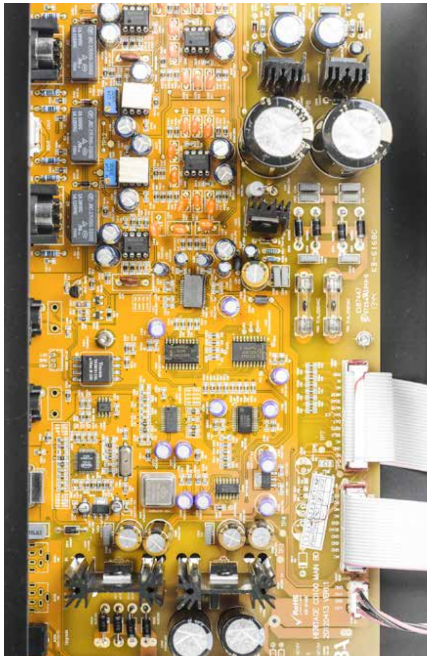
Oznaczenia wzmacniaczy operacyjnych na wyjściu (buforów) zamaskowano. Prócz nich w torze analogowym pracują TL072CP. Wejścia cyfrowe obsługuje Tenor TE7022L (USB 24/96) oraz Cirrus Logix CS8416. Zastosowano także upasampler SRC41921.
